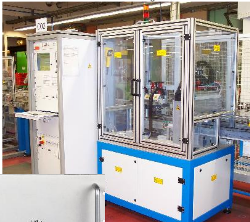
Windungsschlussprüfgerät EW-100.02A Integriert in eine Inline-Prüfanlage
